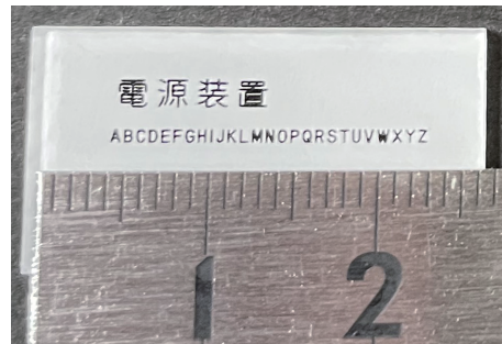
機械彫刻用標準書体(JIS書体)をレーザーで彫刻した極小文字
